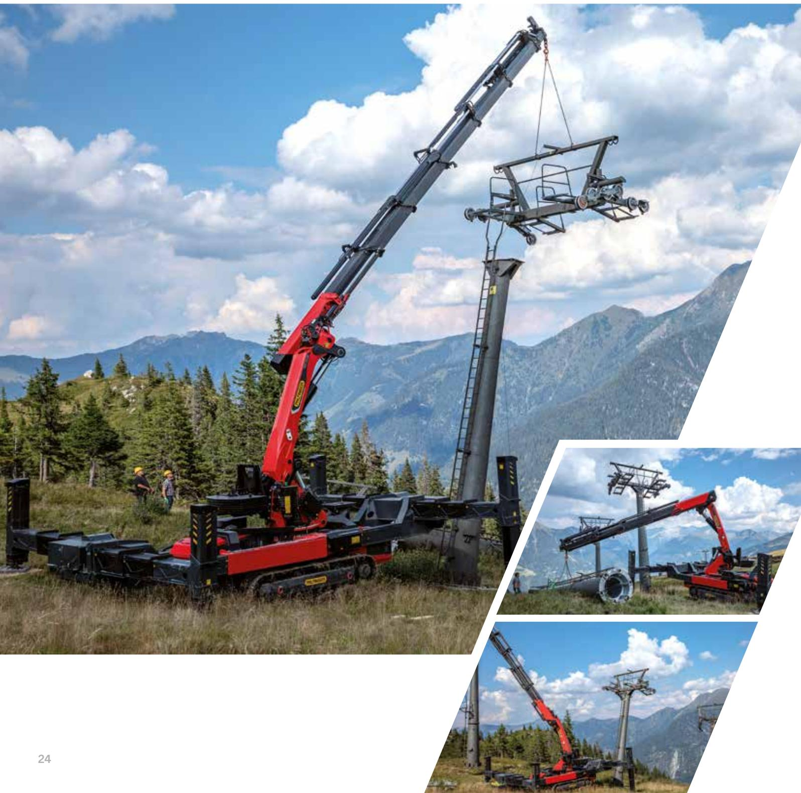
**Test sur le terrain : lors du démontage de pylônes de télésiège dans la vallée de Gastein, la grue sur chenilles PALFINGER PCC 115.002 a démontré ses atouts sur un terrain très difficile.**
