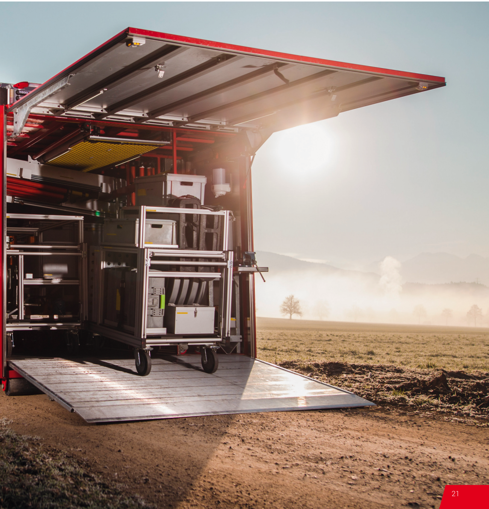
Abrollbehälter Wasserschutz mit 10 Rollwagen sowie fix verbautem Material, Überfahrampen und Regenschutz.
