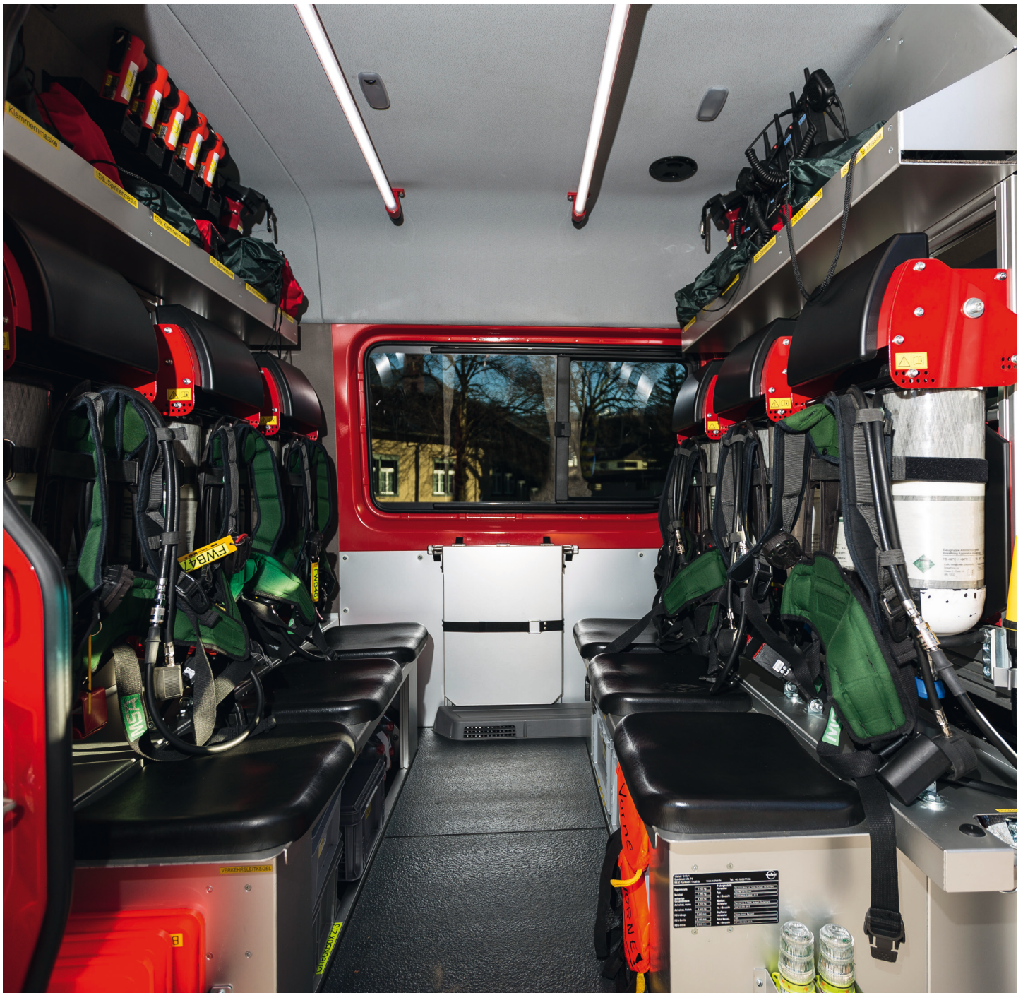
Atemschutzhalterung mit integrierter Rückenlehne, einstellbar auf alle gängigen 1 und 2 Flaschen Atemschutzgeräte
