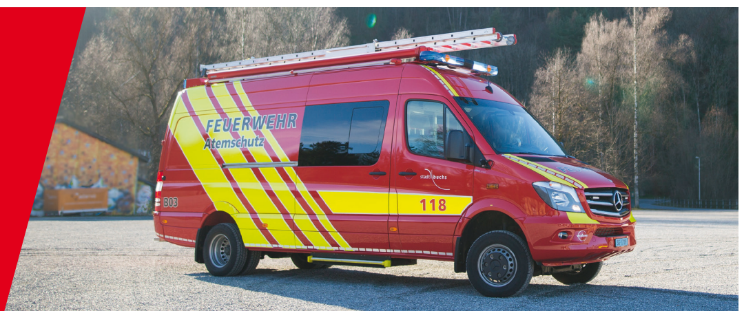
Sonderfahrzeug bis 7,5 to mit 5 Geräteraum, davon 1 Geräteraum mit Platz für 2 Rollwagen, diverses fix verlastetes Material, ausgebauter Mannschaftsraum und WLS
